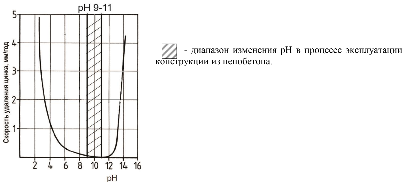
Рисунок 1 – Степень стойкости цинкового покрытия в зависимости от pH
