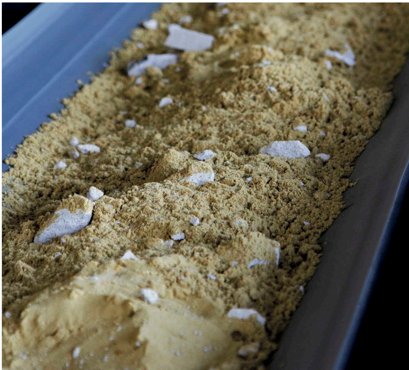
Возврат дробленого брака в производство
