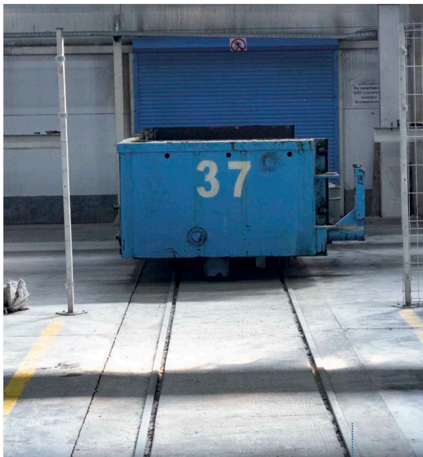
Форма перед зоной предварительного твердения (созревания)
