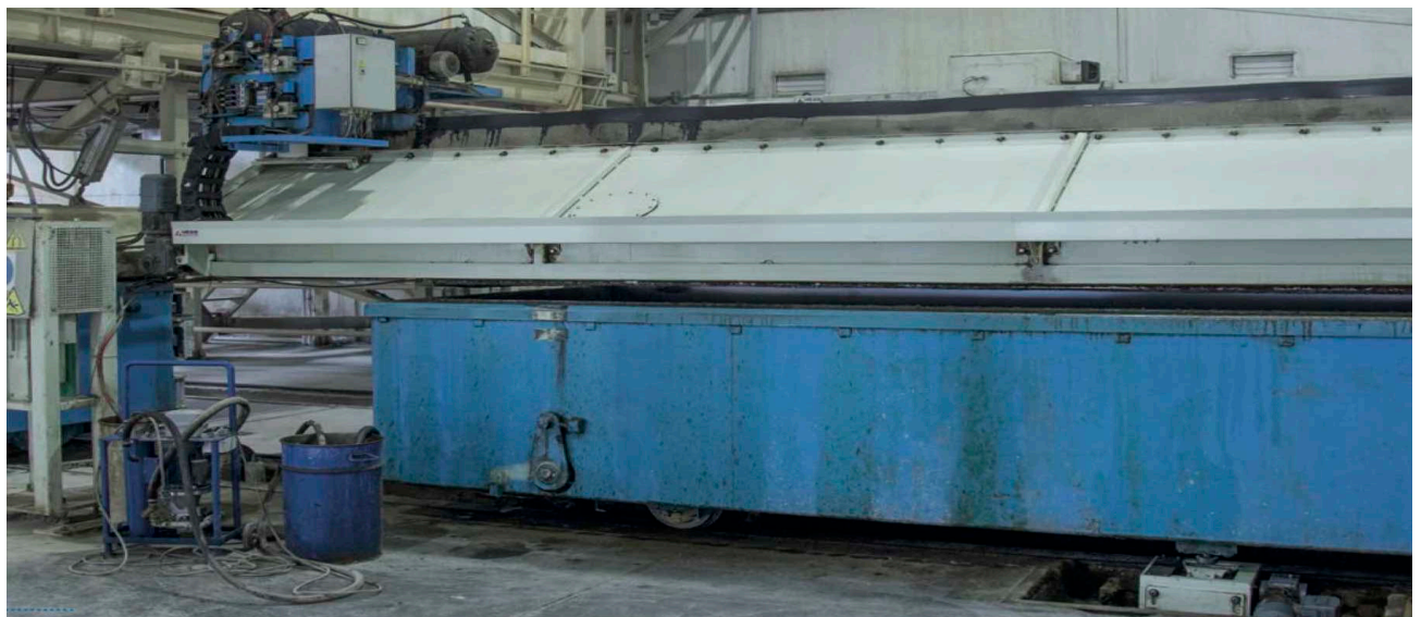
Форма в зоне смазки машиной Münstermann
