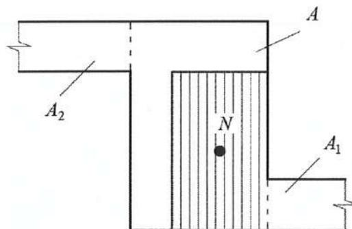
Рисунок 7.5 – Расчетная схема сложного сечения при косом внецентренном сжатии; площади  $A_1$  и  $A_2$  в расчете не учитываются
