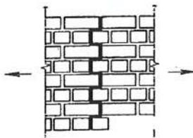
**Рисунок 6.2 – Растяжение кладки по перевязанному сечению**
