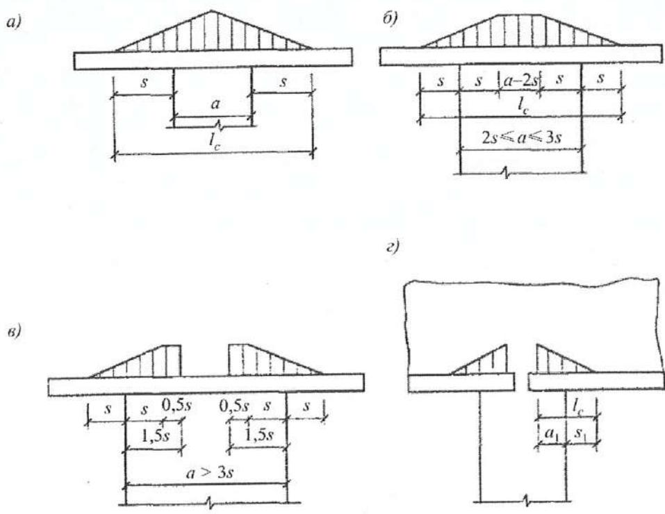
*a* – на средних опорах неразрезных балок при  $a \leq 2s$ ; *б* – то же, при  $3s \geq a > 2s$ ; *в* – то же, при  $a > 3s$ ; *г* – на крайних опорах неразрезных балок и на опорах однопролетных рандбалок
