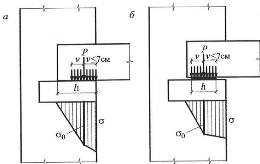
*a* – опирание балки без фиксирующей прокладки;
