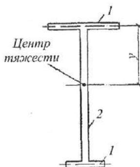
1 – простенок продольной стены; 2 – поперечная стена
