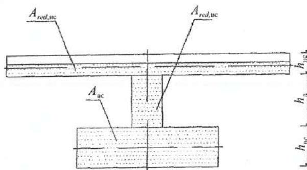
Рисунок 7.7 – Приведенное сечение рассчитываемого фрагмента стены
