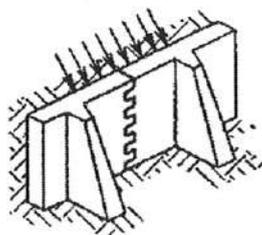
**Рисунок 6.3 – Растяжение кладки при изгибе по перевязанному сечению**
