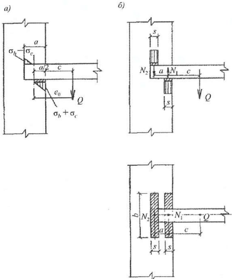
$a$  – без распределительных подкладок;  $b$  – с распределительными подкладками
