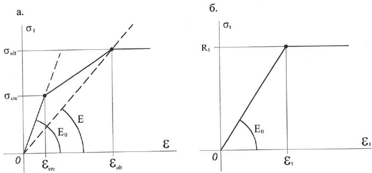
а – продольные деформации укорочения вдоль вектора сжимающего усилия;
