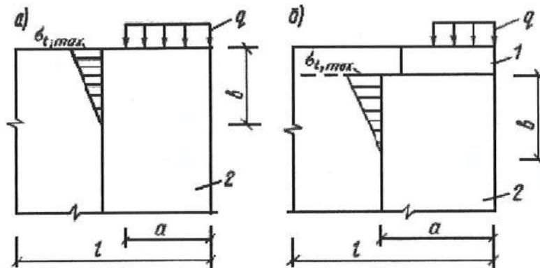
*a* – при отсутствии распределительной плиты; *б* – при установке распределительной плиты;
