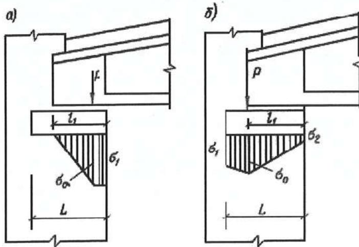
*a* – нагрузка и напряжения при расчете кладки на местное сжатие под опорной плитой;
