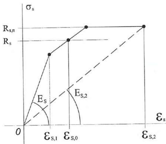
Рисунок Е.3 – Расчетная диаграмма деформирования стали
