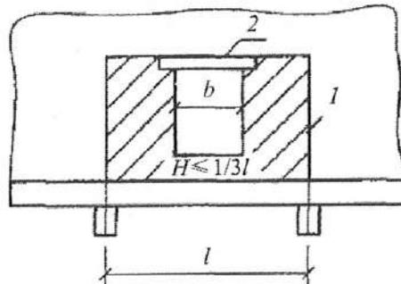
1 – нагрузка на рандбалку; 2 – железобетонная перемычка
