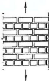
**Рисунок 6.1 – Растяжение кладки по перевязанному сечению**
