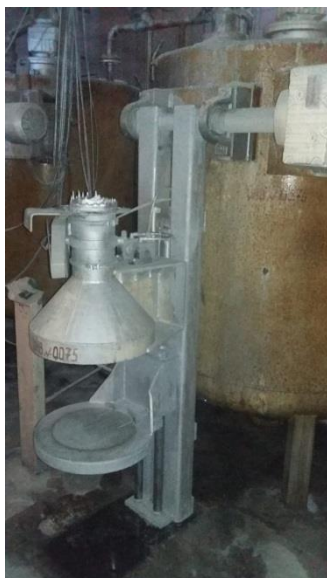
Рис. 4. Автоматический кантователь барабанов с газообразователем
